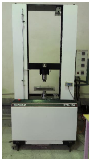
شکل ۵. نمای دستگاه آزمایش یونیورسال جهت انجام آزمایش‌های شکست بر روی نمونه‌های SCB
