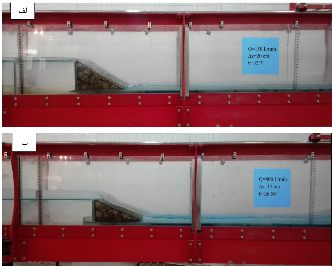
شکل ۲. نمایی از مدل آزمایشگاهی الف) جریان درون گذر و ب) جریان روگذر از گابیون
