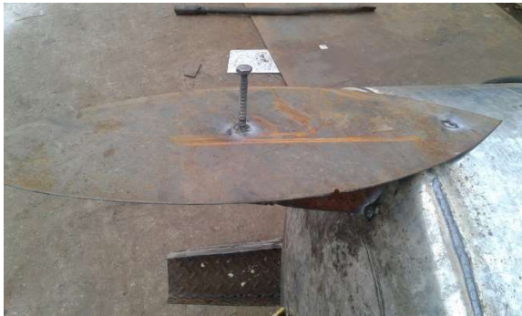
شکل ۲. الف) گل‌میخ‌های نصب شده بر روی ورق در یکی از نمونه‌ها، ب) آزمایش جوش گل‌میخ با توجه به آیین‌نامه جوش آمریکا According to AWS code Fig. 2. (a) Shear connectors welded to steel plate, (b) Bending test on the shear stud
