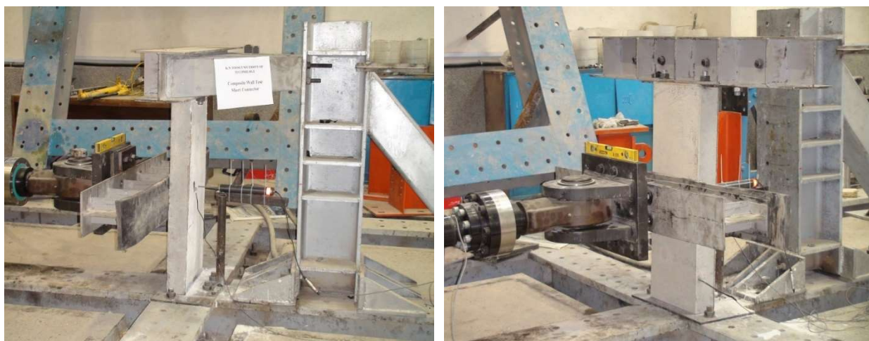
شکل ۴. چیدمان نمونه‌های آزمایشگاهی Fig. 4. Test set-up details
