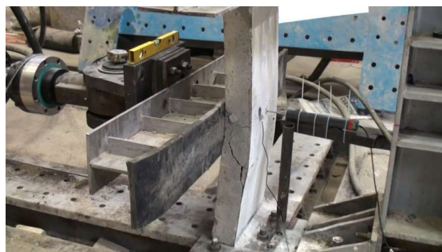
شکل ۸. تغییرشکل نمونه دوم در پایان آزمایش Fig. 8. Deformed shape of W2 specimen
