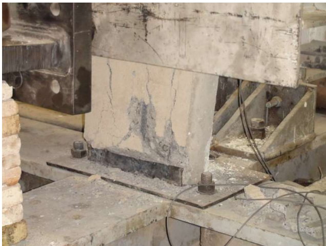
شکل ۱۲. تغییرشکل نمونه ششم در پایان آزمایش Fig. 12. Deformed shape of W6 specimen
