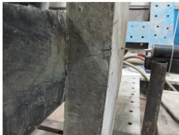
شکل ۱۰. تغییرشکل نمونه چهارم در پایان آزمایش Fig. 10. Deformed shape of W4 specimen
