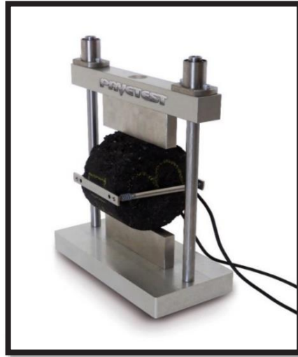
شکل ۳. قاب بارگذاری آزمون خستگی کشش غیرمستقیم در دستگاه ناتینگهام مورد استفاده در این پژوهش
