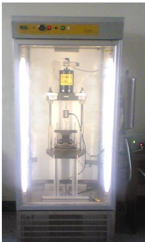
شکل ۲. نحوه بارگذاری روی نمونه‌ها در آزمایش خستگی
