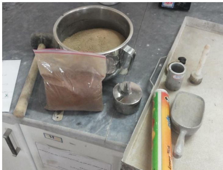
شکل ۳. آماده سازی نمونه‌های تک محوری، تثبیت شده با درصدهای مختلف از افزودنی
