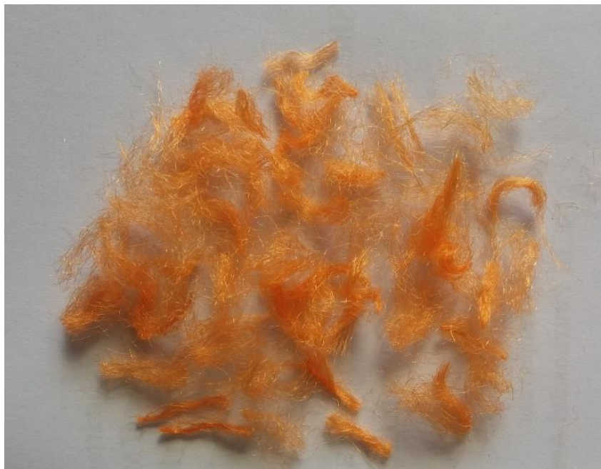
شکل ۴. تصویری از الیاف ضایعات نخ BCF استفاده شده در مسلح‌سازی نمونه‌ها Fig. 2. A view of the BCF waste polypropylene fibers used in reinforcing
