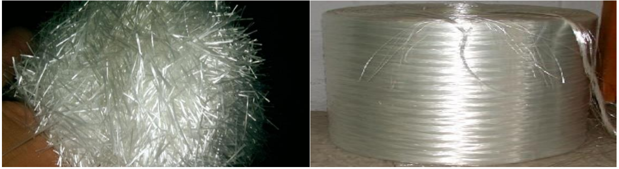
شکل ۲. الیاف شیشه‌ای مورد استفاده در این تحقیق Fig. 2. Glass fibers used in this study
