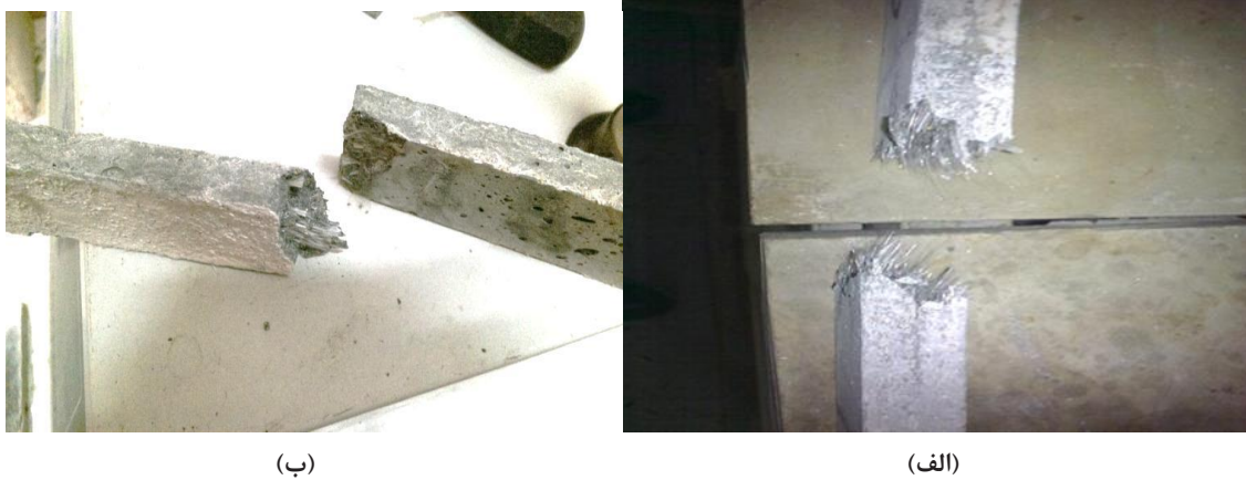
شکل ۱۷. الف) نمونه ی تقویت شده با ۱/۵٪ الیاف در روش پیش مخلوط؛ ب) نمونه ی تقویت شده با ۶٪ الیاف در روش اسپری Fig. 17. (a) 1.5% fiber reinforced sample in pre-mixed method; b) 6% fiber reinforced sample in spray method
