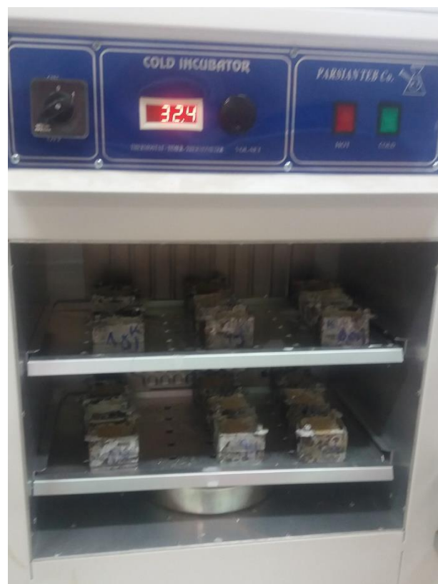
شکل ۵. سلول‌های حاوی نمونه‌های سیمانی سازی شده در دستگاه انکوباتور به منظور عمل آوری آنها
