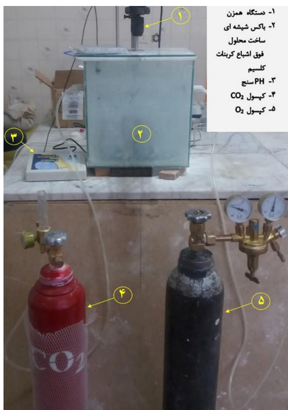
شکل ۴. تصویر دستگاه سمنتاسیون کربناتی ماسه کربناته
