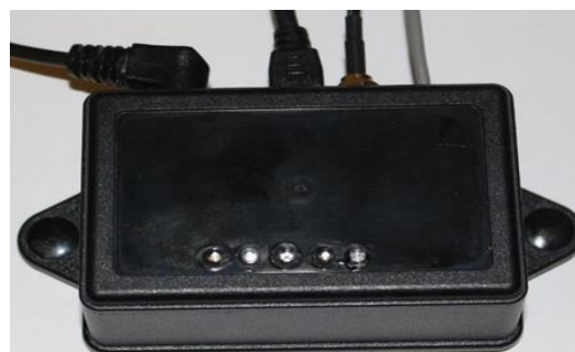
شکل ۳. قاب مخصوص محل قرارگیری مدار طراحی شده. (الف) نمای بالایی مدار (ب) نمایی از قاب به همراه سوکت و دکمه‌های مدار
