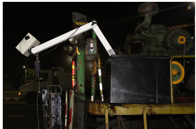
شکل ۴. تصویر قرارگیری دستگاه بر روی ماشین قیرپاش
