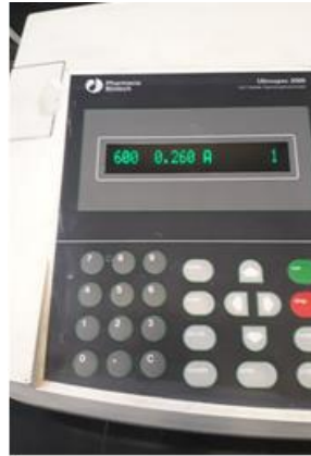
شکل ۲. اندازه گیری چگالی نوری محلول میکروبی
