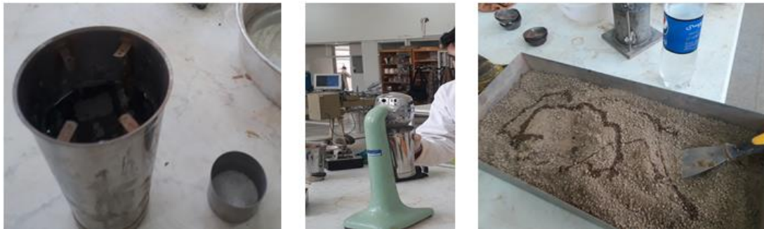
شکل ۴. تهیه و اختلاط محلول پلی الکترولیت کاتیونی
