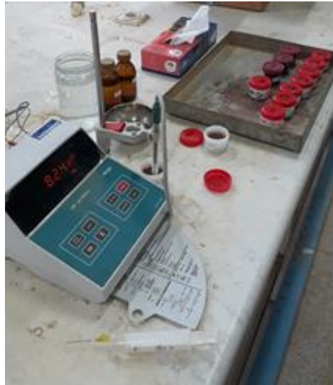
شکل ۶. اندازه گیری pH نمونه های خاک Fig. 6. pH measurement of soil
