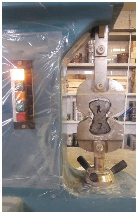
شکل ۵. نحوه انجام آزمایش مقاومت کششی Fig. 5. Procedure of the Tensile Strength Testing
