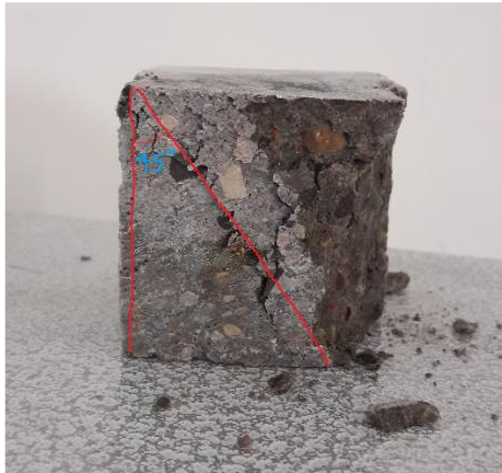
ب) نحوه شکست نمونه‌ها
