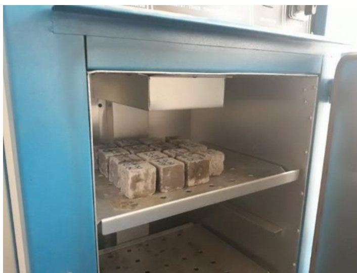
شکل ۷. تصاویر نمونه‌ها درون گرمکن الکتریکی Fig. 7. Images of the Specimens inside the Oven
