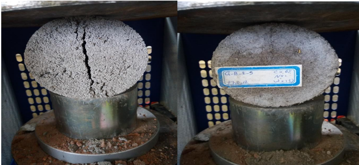
شکل ۵. نحوه بارگذاری نمونه‌ها در آزمایش کشش غیر مستقیم Fig. 5. Test setup for Indirect tensile Strength
