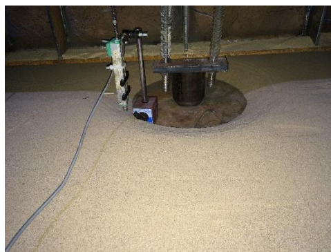
شکل ۶. نمایش تغییرمکان و بالازدگی خاک اطراف شالوده به واسطه بارگذاری تا نقطه گسیختگی در شرایط H/B=3
