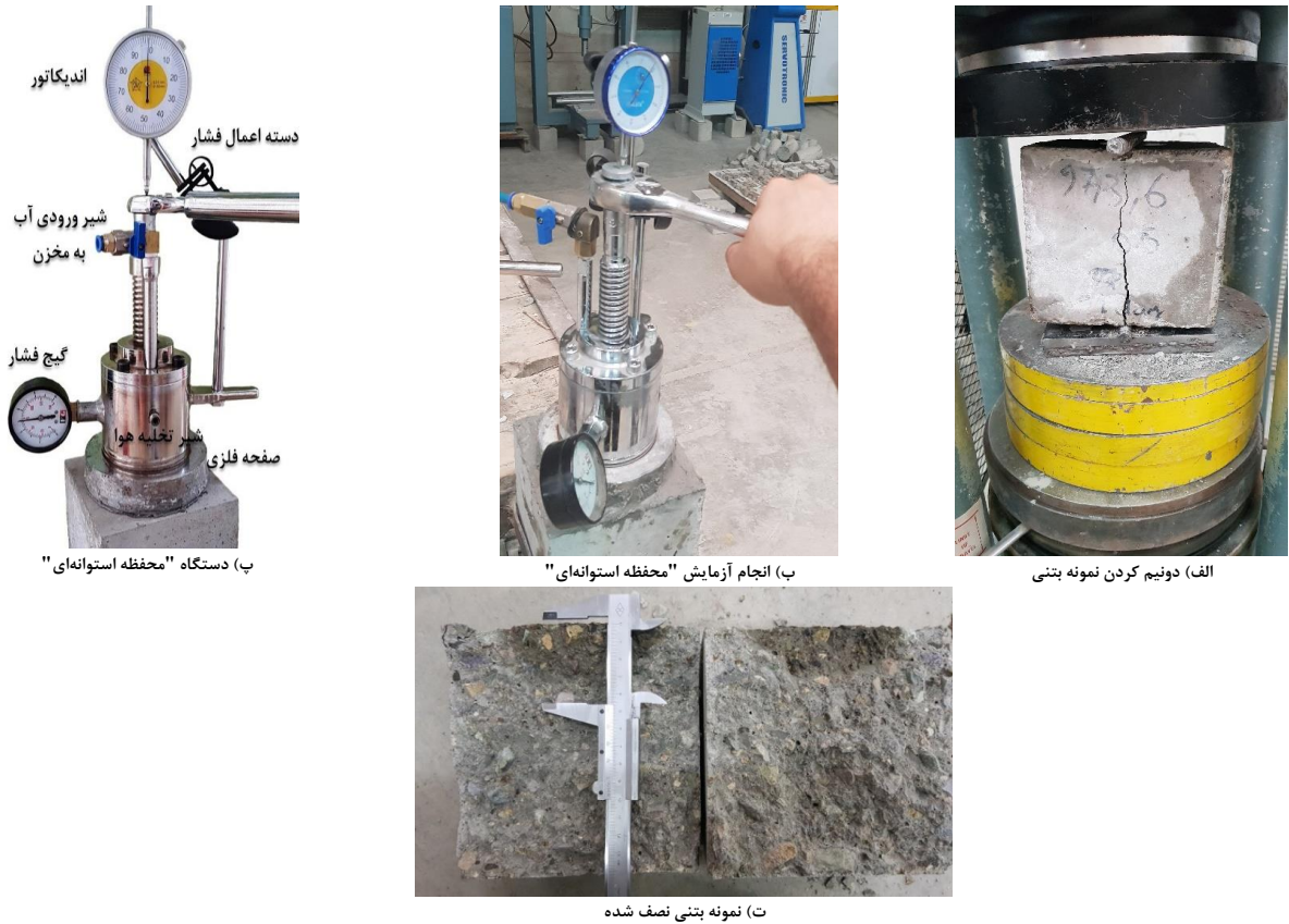
شکل ۲. دستگاه و آزمایش "محفظه استوانه‌ای" [۳۲]
