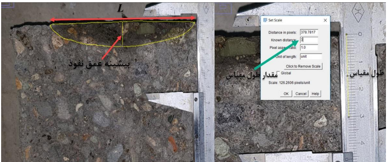
شکل ۳. طول مقیاس و سطح ترشدگی برای نمونه بتنی شکسته شده پس از اتمام آزمایش نفوذپذیری با استفاده از روش "محفظه استوانه‌ای" [۳۲].
