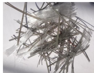
شکل ۱. شکل ظاهری الیاف فولادی موج‌دار با قلاب انتهایی و الیاف پلی‌پروپیلن اصلاح شده
