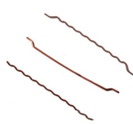
شکل ۱. شکل ظاهری الیاف فولادی موج‌دار با قلاب انتهایی و الیاف پلی‌پروپیلن اصلاح شده
