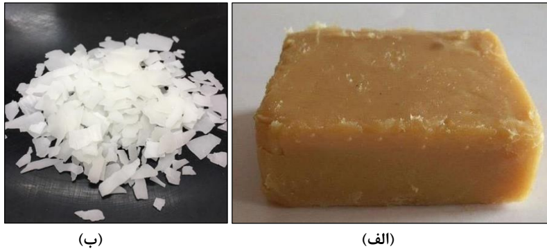
شکل ۱. افزودنی‌های مورد استفاده در این پژوهش، (الف) اسلک وکس (ب) پلی پروپیلن وکس
