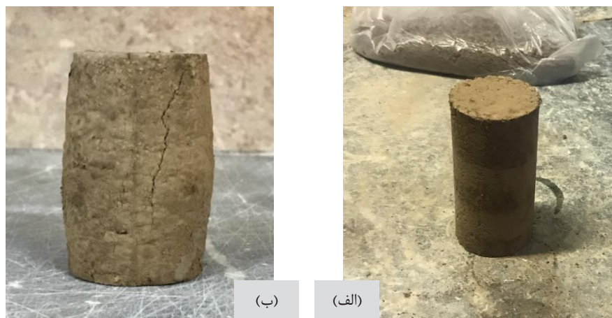
شکل ۴. تصویر نمونه آماده شده، الف) قبل از بارگذاری، ب) بعد از بارگذاری Fig. 4. Prepared specimen, a) before loading, b) after loading
