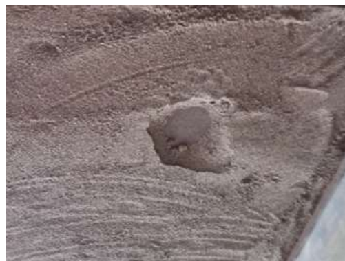
شکل ۵. عدم پایداری خاک تثبیت شده با پلی لاتیس ۷ روزه در سرعت باد ۱۷ متر بر ثانیه
