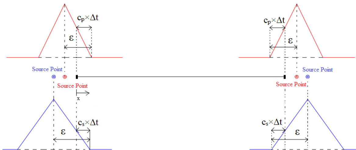
شکل ۳. موقعیت صحیح قرارگیری نقاط منبع در ابتدا و انتهای تیر تیموشنکو
