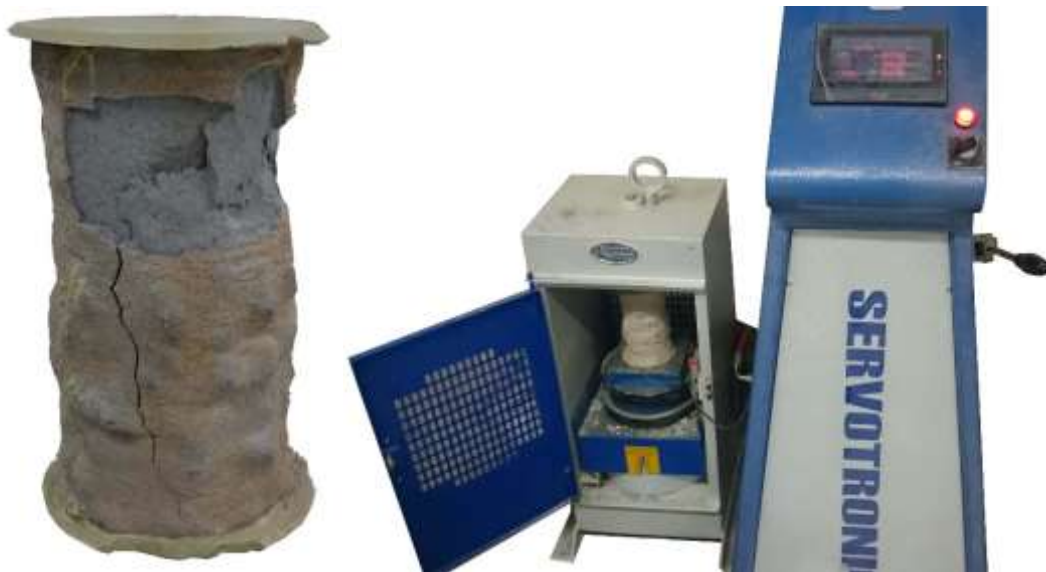
شکل ۱۱. قسمت پایینی ستون J-7-r (الف) در دستگاه تنش کنترل (ب) ستون پس از انجام آزمایش فشاری Fig. 11. Deformation of the excavation wall (a) in the second phase of excavation (b) in the third phase of excavation for Model 2
