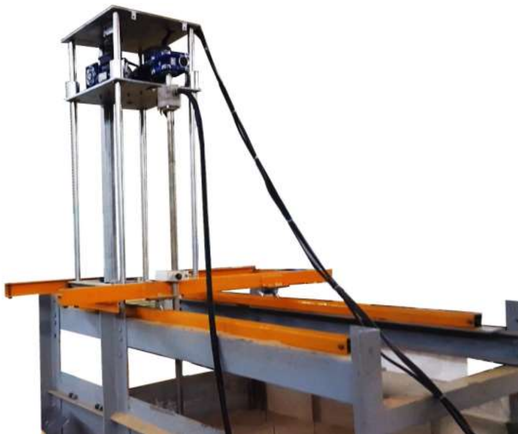
شکل ۲. دستگاه میکرو جت گروتینگ به همراه محفظه فولادی و سیستم انتقالی آن [۵]
