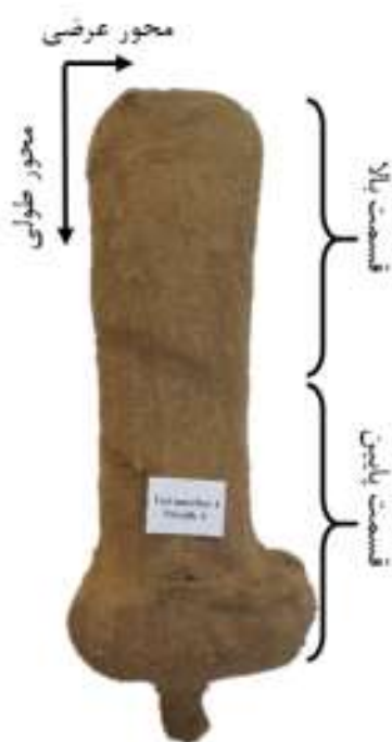
شکل ۷: تقسیم‌بندی قسمت‌های مختلف ستون Fig. 7. Model 1 in the centrifuge after reaching the failure acceleration of 80 g
