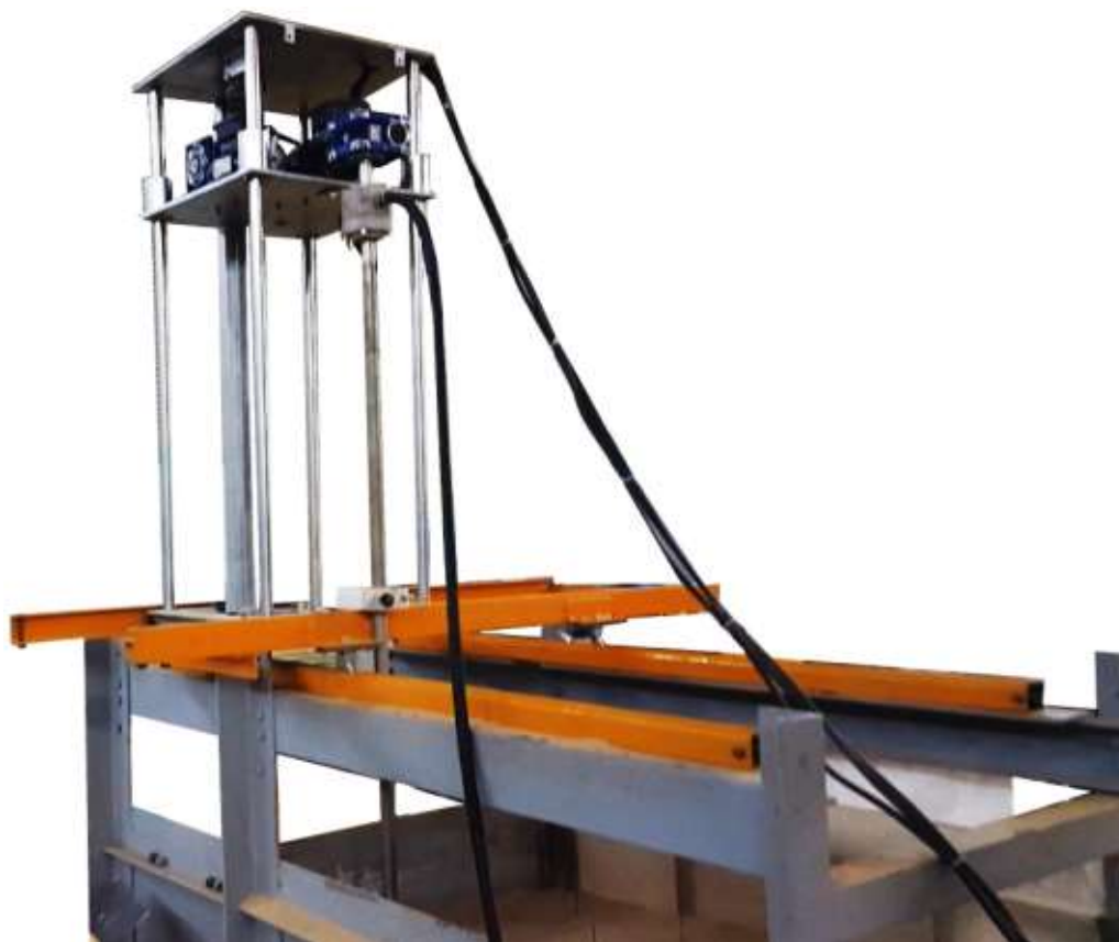
شکل ۲. دستگاه میکرو جت گروتینگ به همراه محفظه فولادی و سیستم انتقالی آن [۵]
