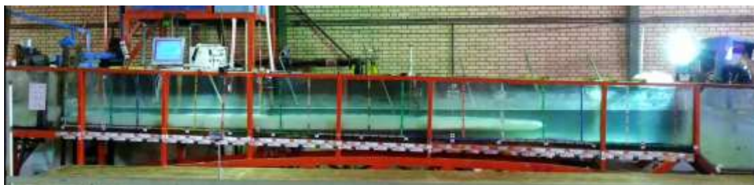
شکل ۲: آزمایش در حال اجرا در سیال پیرامون لایه بندی شده
