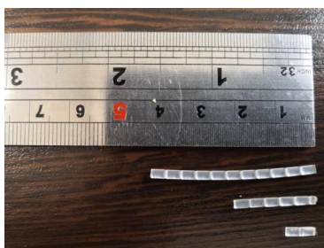
شکل ۲. الیاف ماکروسنتتیک و ابعاد آن‌ها Fig. 2. Macro-synthetic fibers and their dimensions
