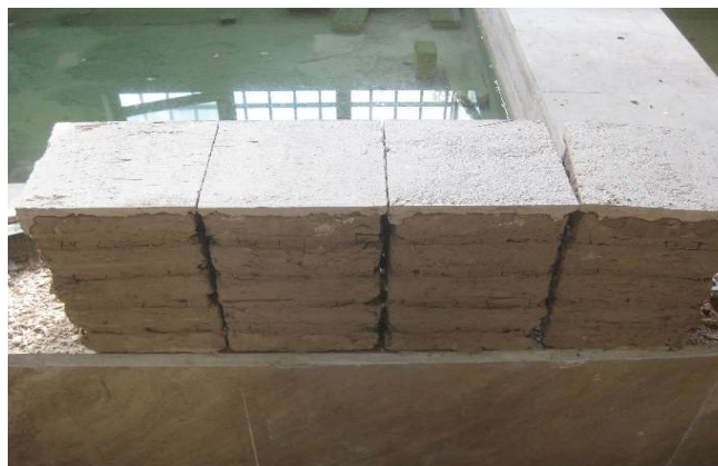
شکل ۵. نمونه های مورد استفاده برای تعیین مقاومت فشاری منشور خشتی Fig. 5. Adobe prism specimens for compression test
