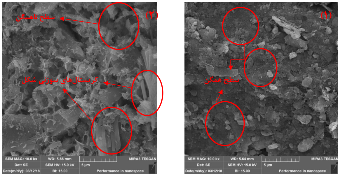
شکل ۱۶. تصویر SEM نمونه های ۹۰ روزه (۱) TS452 و (۲) TS45 با بزرگ نمایی 10 \times . Fig. 16. The SEM images of 90-day specimens (1) TS452 and (2) TS45 with 10 kx magnification
