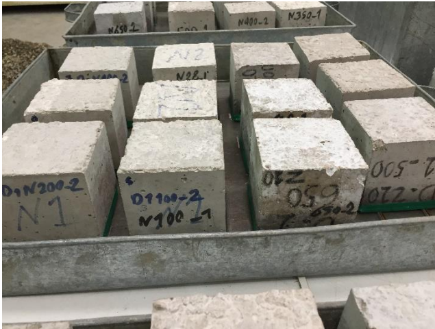
شکل ۵. تصویر برخی از نمونه‌ها حین آزمون جذب آب سطحی Fig. 5. Picture of some specimens during surface water absorption test
