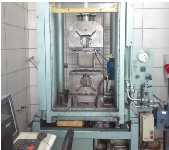
شکل ۴. آزمایش Pull out Fig. 4. The pull-out test
