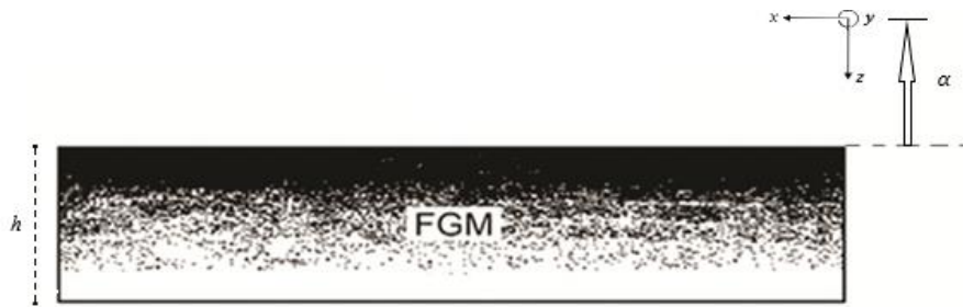
شکل ۲: نمای شماتیک صفحه‌ی FGM و موقعیت محور مختصات در صفحه . Fig. 2. Schematic of the FGM plate and coordinate axis position on the plate.
