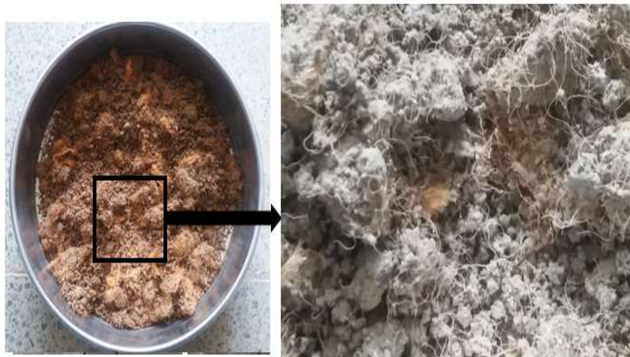
شکل ۵: نمونه‌ای از مخلوط خاک و الیاف Fig.5. a sample of soil and fibers mix
