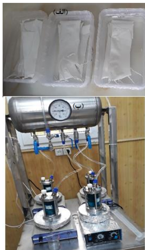
شکل ۳. (الف) تصویر غشاهای سنتز شده (ب) و دستگاه تست غشاء انتها بسته
