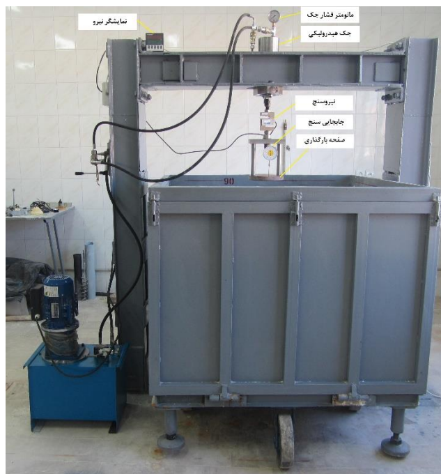
شکل ۲. دستگاه آزمایش بارگذاری Fig. 2. Loading test device
