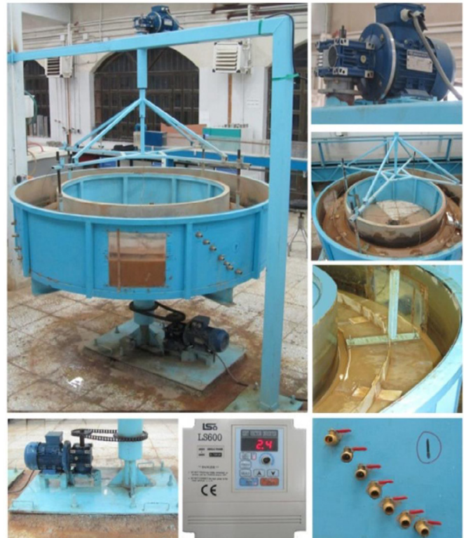
شکل ۲. اجزای فلوم دایره ای Fig. 2. Annular Flume assembly
