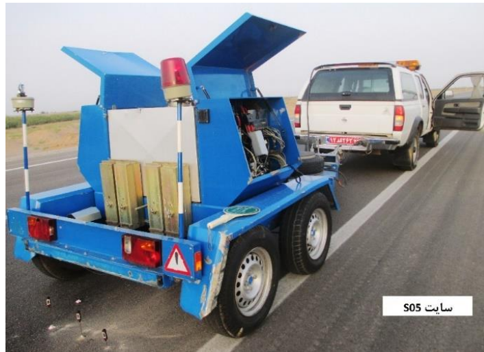
شکل ۲. آزمایش FWD همراه با اندازه‌گیری دمای عمق لایه آسفالتی در یک سایت روسازی
