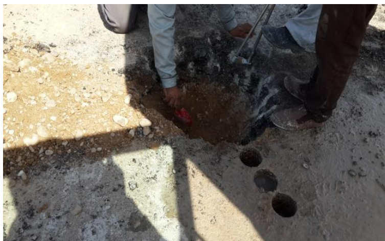
شکل ۳. انجام سونداز و مغزه‌گیری در یک سایت روسازی
