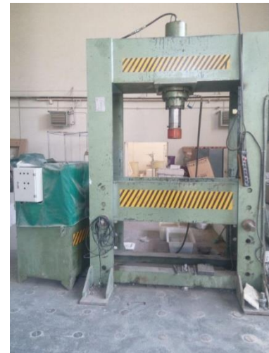
شکل ۸. جک با ظرفیت اسمی ۱۰۰ تن Fig. 8. Jack with a nominal capacity of 100 tons
