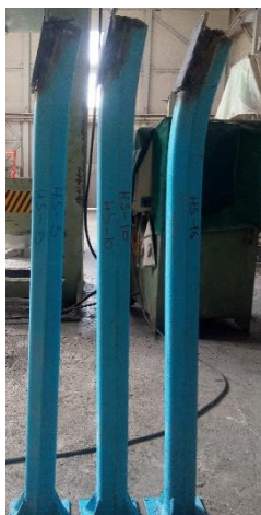
شکل ۳۴. نمونه‌های پر شده با بتن الیافی بعد از بارگذاری با خروج از مرکزیت ۵، ۱۰ و ۱۵ سانتی‌متر
