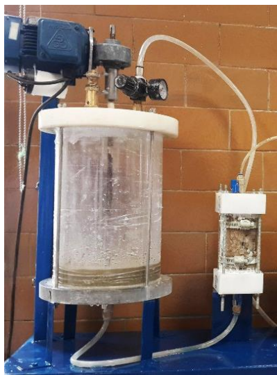
شکل ۳. تجهیزات تزریق Fig. 3. Grouting equipment
