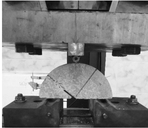
شکل ۷. نمایی از چگونگی قرار گیری نمونه نیم دایره‌ای ترک خورده در دستگاه
