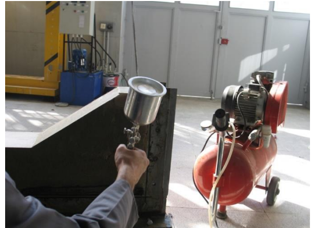
شکل ۸. پاشیدن ماسه رنگی به سطح نمونه برای استفاده از روش PIV Fig. 8. Spread of sand particles on model surface for using of PIV method
