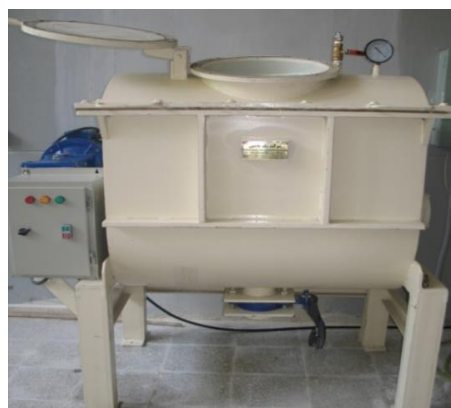
شکل ۳. میکسر رس و کیوم‌دار جهت تهیه دوغاب اشباع همگن Fig. 3. Vacuum clay mixer
