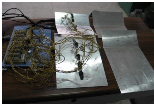
شکل ۷. کرنش‌سنج‌های نصب شده در سطح رویه مدل Fig. 7. Strain gauges of lining model
