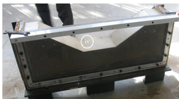
شکل ۱. جعبه آزمایش ساخته شده جهت مدل سازی های فیزیکی Fig. 1. Configuration the laboratory test box
