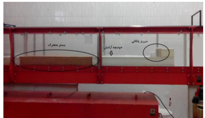
شکل ۲. نمایی از قرارگیری سرریز پلکانی، حوضچه آرامش و بستر متحرک در فلوم آزمایشگاهی
