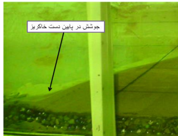
شکل (۸): جوشش در پایین دست خاکریز
