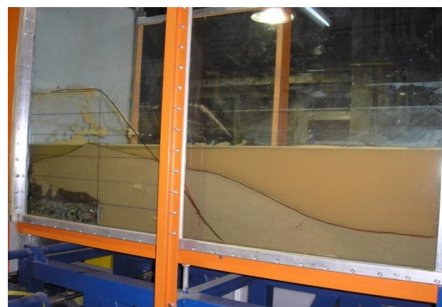
شکل (۱۰): نمای نهایی خاکریز با شیب ۱۳ درجه
