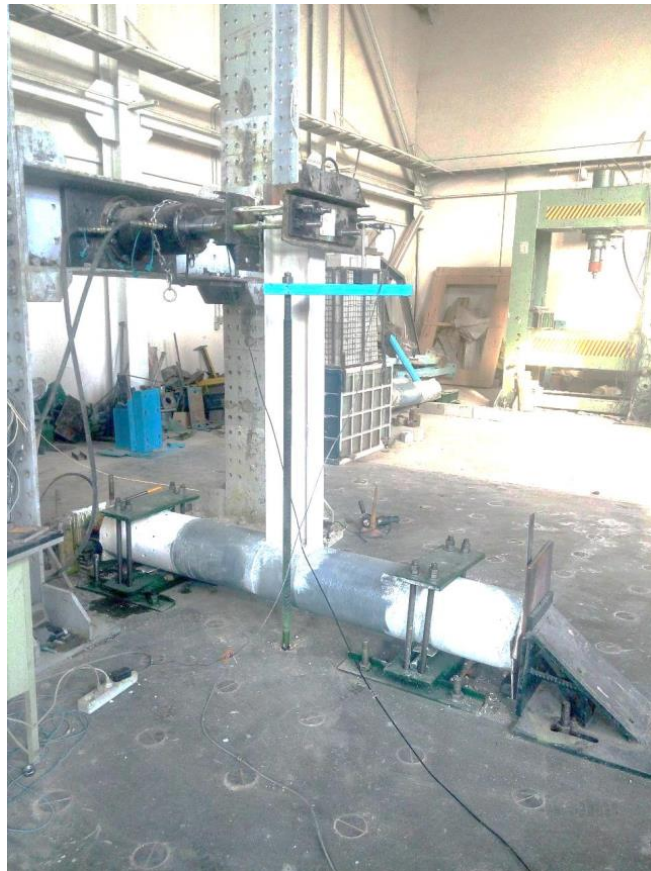
شکل ۵. تجهیزات آزمایش نمونه پنجم Fig. 5. Test set-up of specimen No. 5
