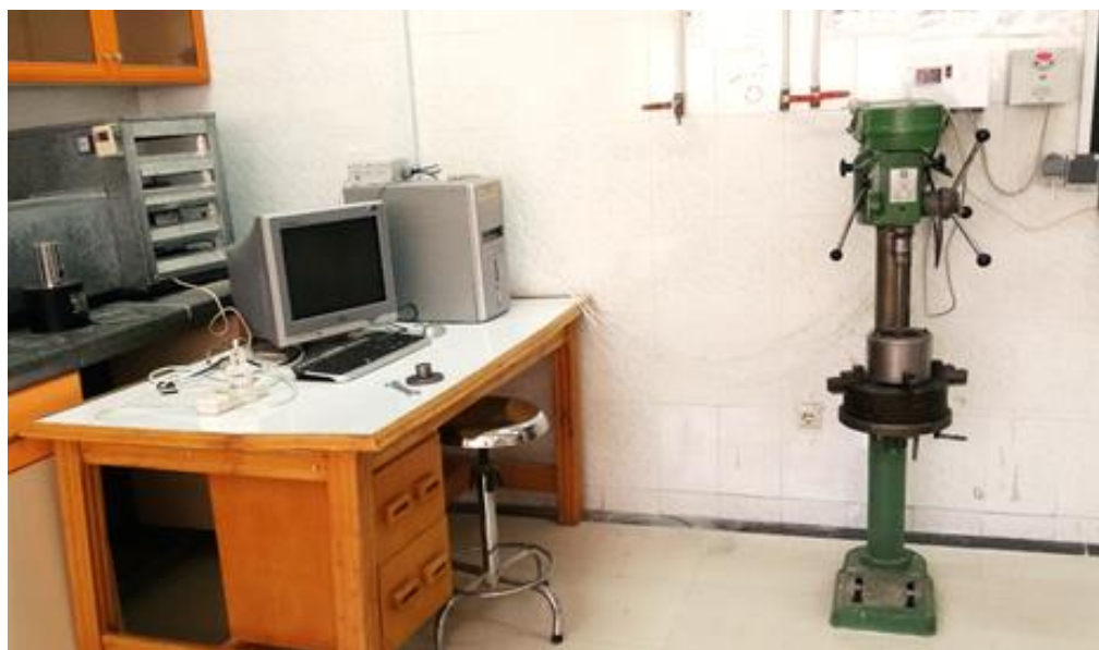
شکل ۱. دستگاه آزمایش LCPC ساخته شده در دانشگاه صنعتی سهند به همراه تجهیزات جانبی Fig. 1. The LCPC testing device and its accessories manufactured at Sahand University of Technology
