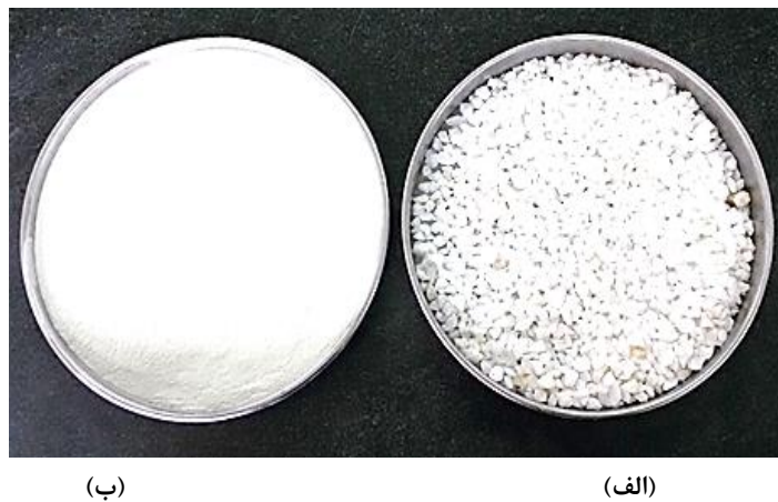
شکل ۳. نمونه سیلیس و تالک مورد آزمایش. (الف) ذرات سیلیس (با ابعاد ۴/۳ - ۶ میلی متر)، (ب) ذرات رسی (تالک) Fig. 3 The tested silica and talc samples. a) silica particles (4.0 - 6.3 mm). b) clay particles (talc)
