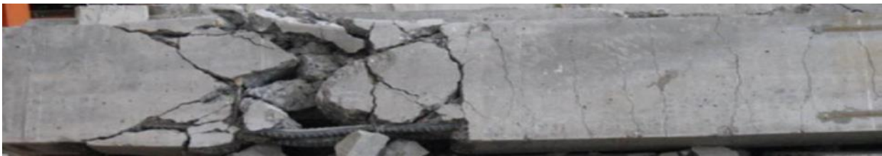
شکل ۱۷. مدل شکست X شکل بین تکیه‌گاه و محل اعمال بار در تیر بتنی آزمایشگاهی و نشانگر شکست برشی در بارگذاری چرخه‌ای [۷]
