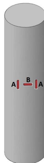
شکل ۷. محل نصب کرنشسنجهای طولی و عرضی Fig. 7. Installation of longitudinal and transverse strain gauges
