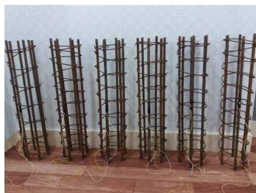
شکل ۳. نحوه نصب کرنشسنجها روی میلگردها Fig. 3. How to install strain gauges on rebars
