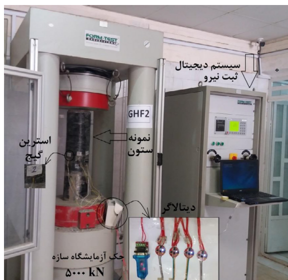
شکل ۸. ست آپ آزمایش و قرارگیری ستونها در جک Fig. 8. Test setup and placement of columns in the jack
