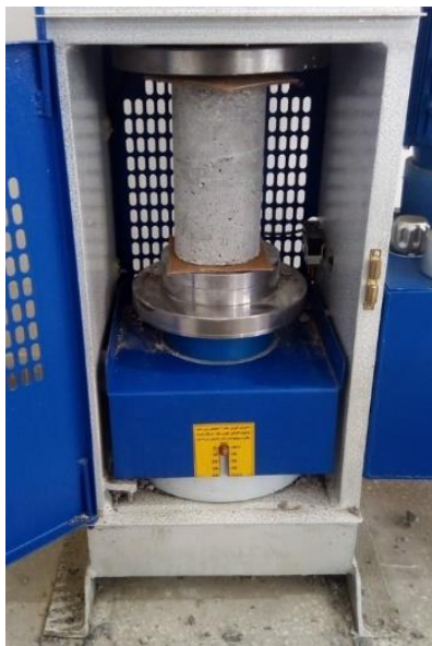
شکل ۴. نحوه‌ی قرارگیری نمونه‌ها در زیر جک
