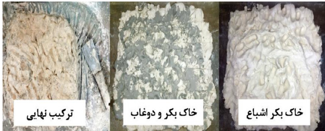
شکل ۸. مراحل مخلوط نمودن ترکیبات شامل خاک، سرباره و آهک هیدراته
