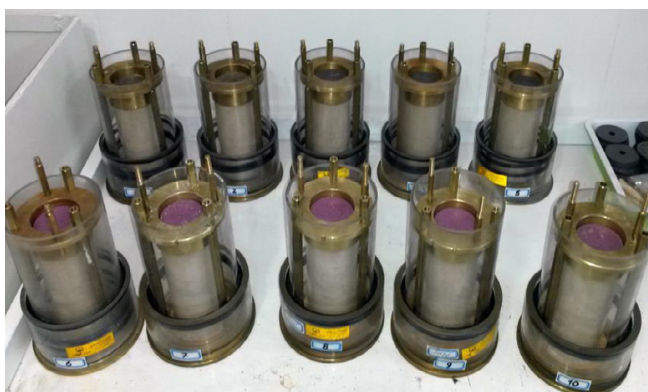
شکل ۹. نمونه‌های ساخته شده درون قالب‌های پلکسی‌گلس و سلول‌های تحکیم
