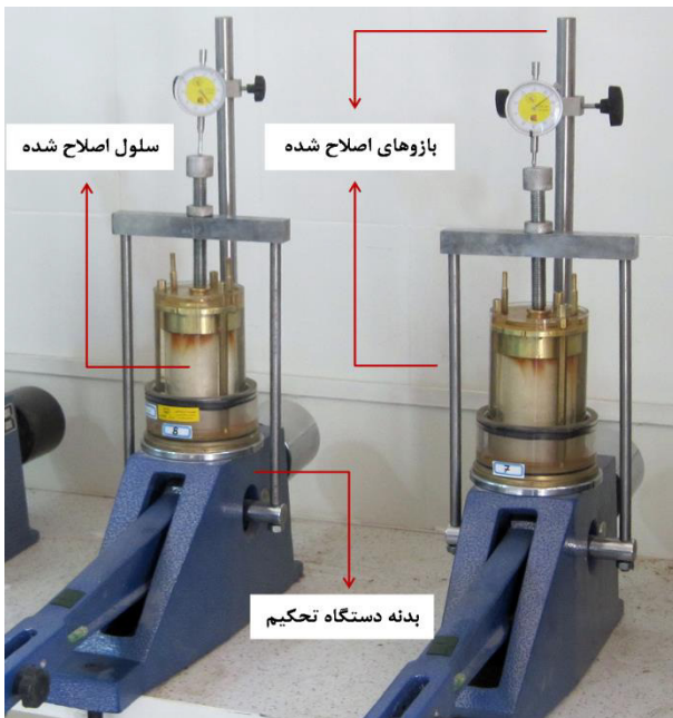
شکل ۷. دستگاه شبیه ساز تنش وارد بر خاک در عمق Fig. 7. Soil overburden pressure simulator
