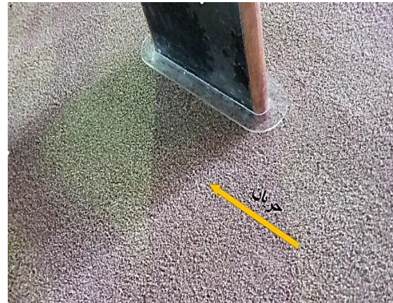
شکل ۴. نمایی از پایه و طوقه نصب شده روی آن Fig 4. A view of the pier and collar placed on it
