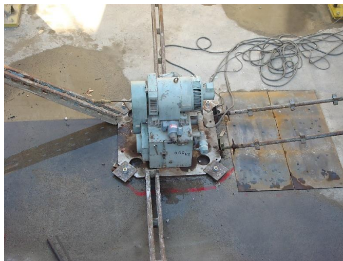
شکل ۲. دستگاه لرزاننده نصب شده بر روی پی میز لرزه
