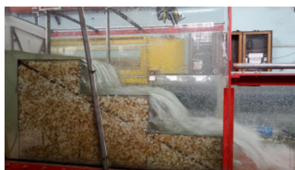
شکل ۲. جریان ریزشی در سرریز ۳ پله‌ای با شیب ۱:۲ و Q=33 \text{ lit/s} , d_{50}=10 \text{ mm}
