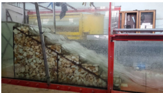
شکل ۳. جریان انتقالی در سرریز ۶ پله‌ای با شیب ۱:۲ و Q=44 \text{ lit/s} , d_{50}=40 \text{ mm}
