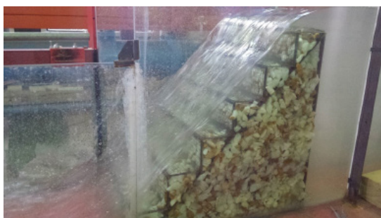
شکل ۴. جریان غیرریزشی در سرریز ۶ پله‌ای با شیب ۱:۱ و Q=55 \text{ lit/s} , d_{50}=25 \text{ mm}
