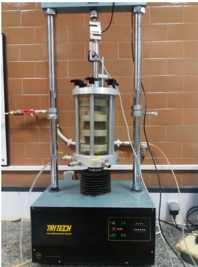
شکل ۴. نمای کلی سیستم بارگذاری نمونه‌های تزریق شده در دستگاه سه‌محوری Fig. 4. The general scheme of triaxial apparatus to load injected samples
